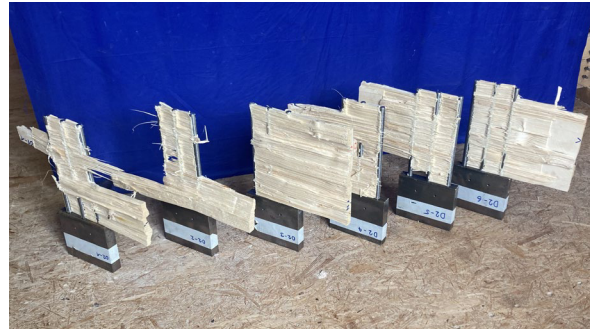
Abbildung 9: Prüfkörper der Serie D2-4 nach der Zerlegung. An der oberen Stangengruppe haftet stets der Holzbereich zwischen den Rollschub-Versagensebenen.
