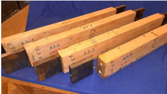
Abbildung 8: Prüfkörper der Serie A3 nach den Prüfungen. Besonders ist der Prüfkörper A3-4 mit Ermüdungsversagen der Duplex-Gewindestange.
