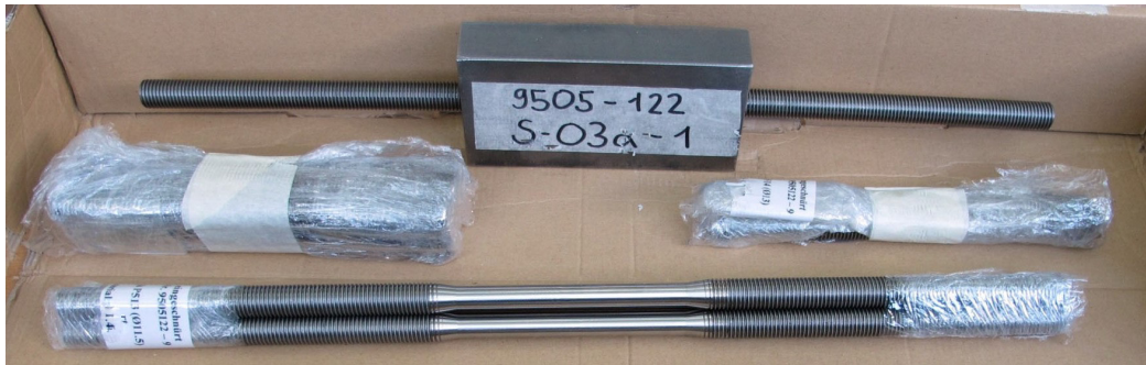
Figur 2: Stahl-Prüfkörper; Verbindung mit Innengewinde (oben) und abgedrehte Gewindestangen (unten)
