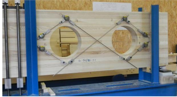
**Abbildung 18:** BSH-Esche 140/720 mm mit 2 Durchbrüchen ø360mm
