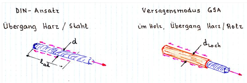
Abbildung 15a und 15b: Bezugsorte des Versagens: Übergang Harz/Stahl bzw. Harz/Holz
