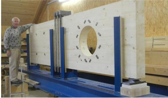
**Abbildung 17:** Schubträger 160/1'000 mm mit Durchbruch ø 500 mm
