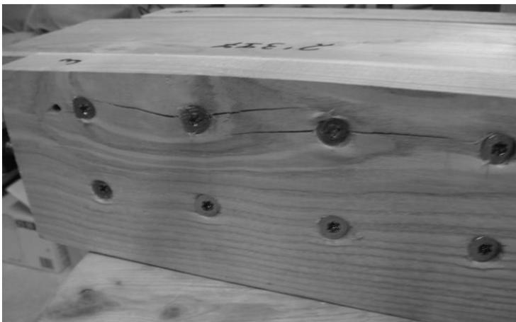
Abbildung 9: Prüfkörper 70° mit angerissener Lasche (vor dem Versuch)
