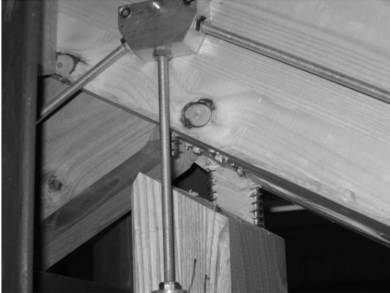
Abbildung 17: Prüfung unterschiedlich konfigurierter Knoten; Schraubenbruch und teilweises Ausreißen (über Rollschub) der Schrauben aus der Gurtung in Fichte
